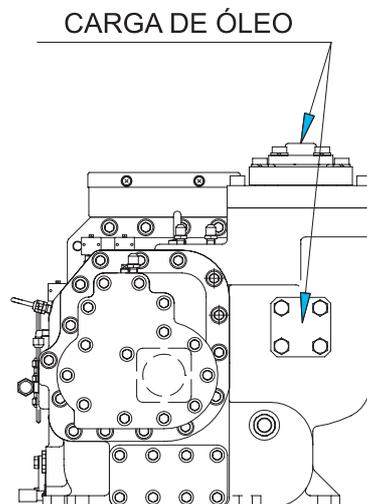
Em nenhum outro ponto do compressor é permitido se fazer a carga de óleo. Esta é a única manutenção permitida no interior do compressor feita por técnico especializado que não seja da Hitachi ou por ela indicado por escrito. O descarte do óleo retirado do compressor deve ser executado conforme legislação local.
