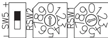
Exemplo de ajuste para saída de água gelada a 15°C
