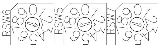
Sendo assim o valor ajustado para controle na configuração acima é de 3,7A por um ciclo de 30 minutos de monitoração.
