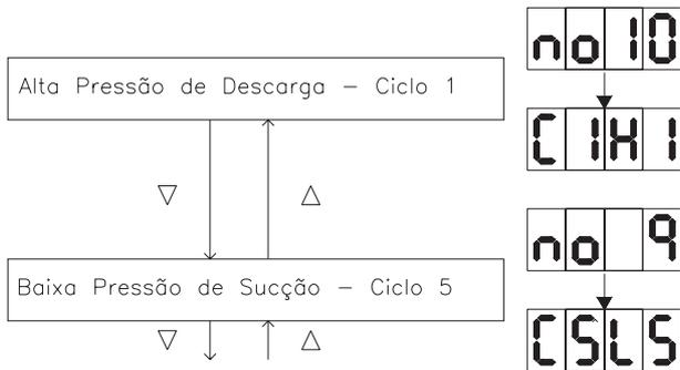
**Nota: Se durante a verificação do registro de alarme ocorrer qualquer alarme este modo e alterado para o alarme ocorrido no instante em que o mesmo ocorrer.**
