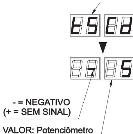
temperatura ajustada em função da posição do potenciômetro.
