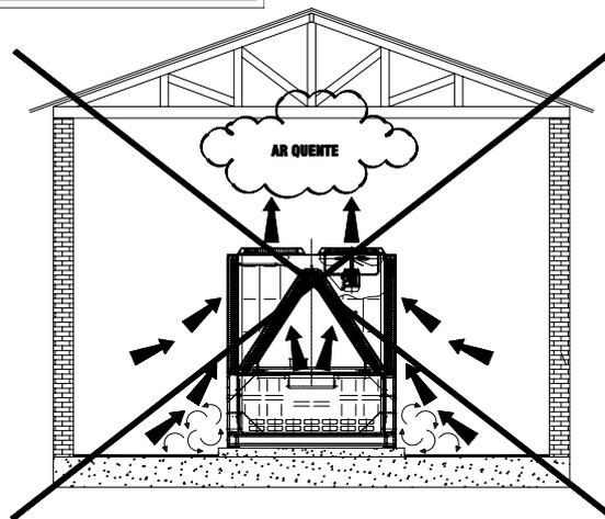
JAMAIS INSTALE O CHILLER EM LOCAIS SOB TELHADOS E/OU QUALQUER TIPO DE COBERTURA. O NÃO CUMPRIMENTO IMPLICARÁ NO NÃO FUNCIONAMENTO DO CHILLER
