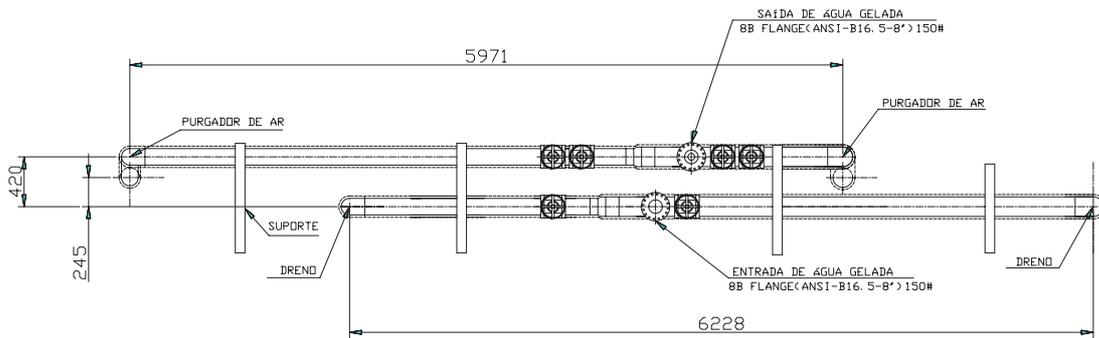
■ Detalhe da tubulação de água para modelos RCU390 e 420SAZ
