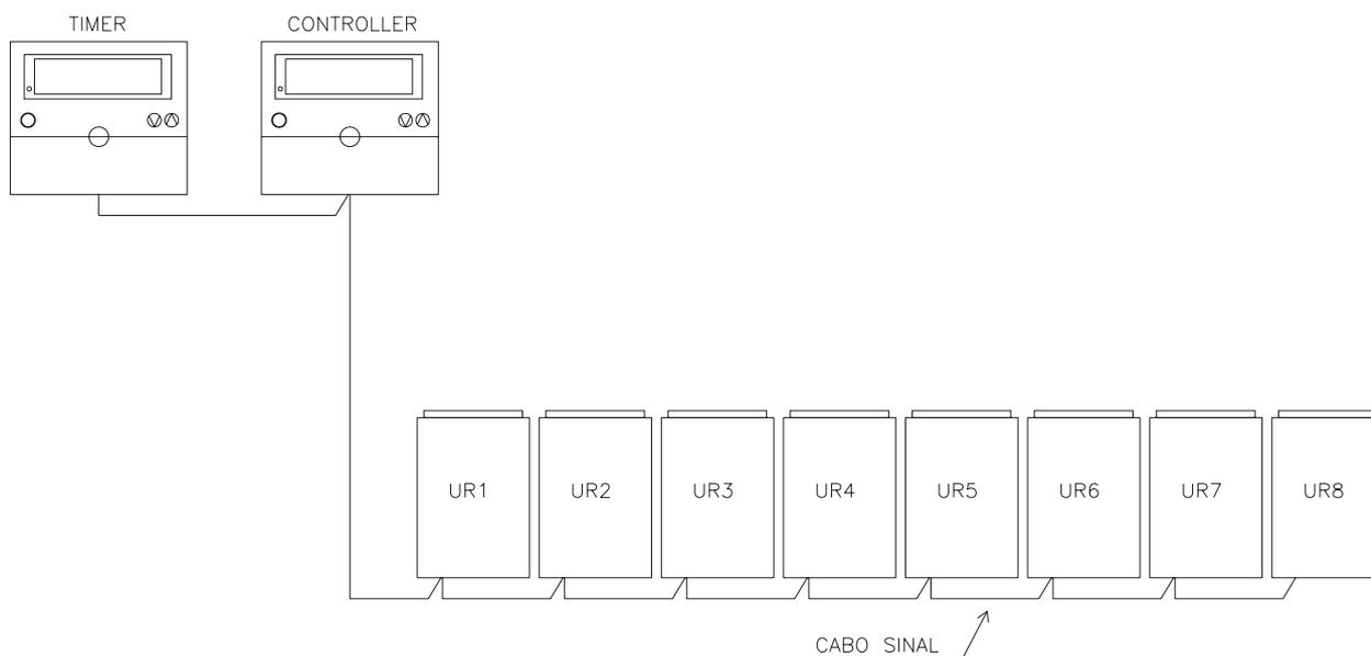
Para controlar de 1 até o máximo de 8 Chillers por controlador pode ser fornecido um controlador que agrega todas as funções dos Chillers em um único painel que pode ser instalado em uma sala de controle central. O controle e monitoração se tornam fáceis e rápidos e sem os elevados custos de um gerenciador central do tipo supervisor quando este não se fizer necessário.
