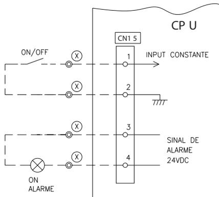
2. **Controle remoto ON/OFF a um contato SECO com sinal de pulso 1º pulso ON / 2º pulso OFF com sinal 24VDC para operação normal > 0VDC / alarme > 24VDC.**
